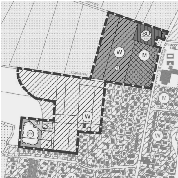
Flächennutzungsplan: B-Plan 19/20, "Lippenkuhle"-Gebiet, ca. 18 ha. M = Mischgebiet (Wohnen und Gewerbe), W = Wohngebiet, SO = Sondergebiet (für Supermarkt)
